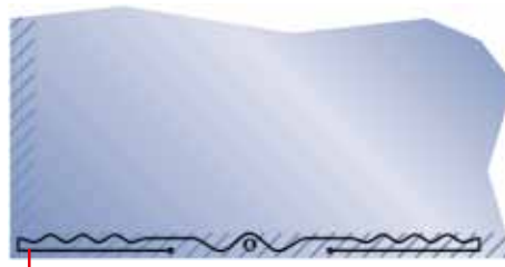
2 Klassische Alarmspinne im nicht sichtbaren Bereich
