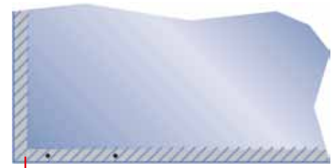
3 Isolierglas: Beschichtung wirkt als unsichtbare Alarmschleife und wird von einer Ausleseeinheit überwacht
